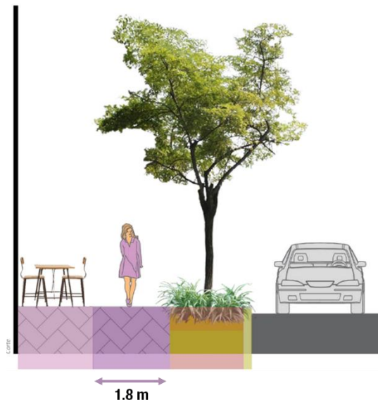
Esquema 21 Ancho mínimo libre para la circulación peatonal en banquetas
